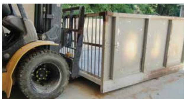
この状態では、フォークリフトのタイヤからの跳ね返りの泥や水がカゴのなかまで入る。床板から上端まで板で覆う必要がある
